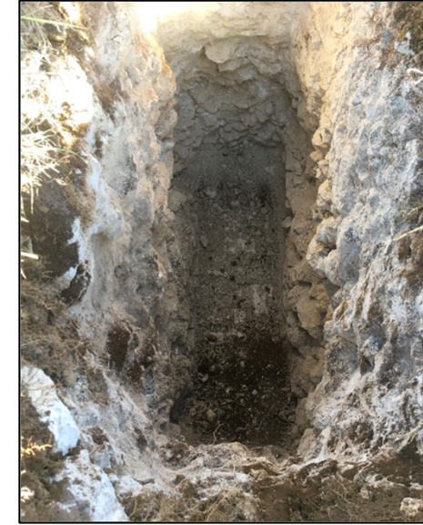
Fosse F3 (prof. 2,00 m) : calcaire graveleux en bancs pluridécimétriques puis décimétriques et altérés, sous 0,30 m de terre végétale limoneuse et légèrement argileuse à graviers calcaires
