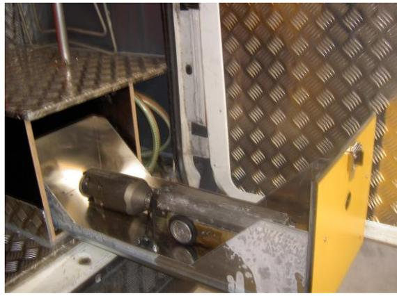
Figure 1 : matériel d'inspection vidéo
